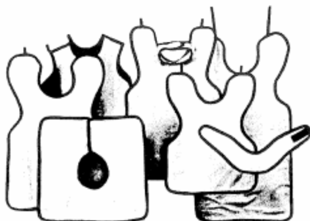
Hình 1.8. Áo chì, cổ áo chì có cả cho trẻ em và người lớn Cổ áo chì có thể tháo rời ra khỏi bộ áo đầy đủ
